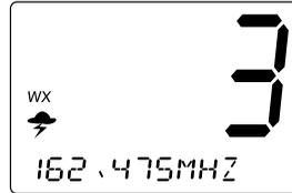
2. Si la radio recibe un tono de 1050 Hz, la marca ⚡ destellará cada otro segundo y el tono de alerta sonará. En el área en donde se emiten señales SAME, se verá la siguiente pantalla.
